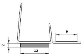
Das weiße, selbstklebende Einfassprofil mit Schaumklebeband dient als Kantenschutz im Innen- und Außenbereich, als Abschluss einer 12,5 mm Bau-/Dämmplatte gegen andere Bauteile bzw. zur Ausbildung von Anschlüssen im Fenster- und Türenbereich und hat zusätzlich einen Abziehstreifen zur Aufnahme von Schutzfolien. Da die Profile eine leichte Vorspannung haben, müssen sie nur aufgeklemt und nicht angespachtelt werden.
