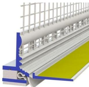
Selbstklebendes PVC-Profil, verbunden mit einer flexiblen TPE-Schlaufe, um dreidimensionale Bewegungen aufnehmen zu können. Das Profil ist mit einer TPE Schutzlippe, verschweißtem VWS-Gewebe, einem schlagregendichten PE-Dichtband sowie einem flexiblen Übergang zum Abziehstreifen zur Aufnahme von Schutzfolien ausgestattet.
