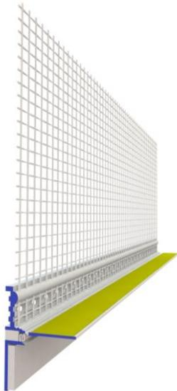
Selbstklebendes PVC Profil für seitliche Anschlüsse an Bauteilen mit Rollläden. Das Profil ist mit einer flexiblen TPE-Schlaufe, verschweißtem VWS-Gewebe sowie einem flexiblen Übergang zum Abziehstreifen zur Aufnahme von Schutzfolien ausgestattet.
