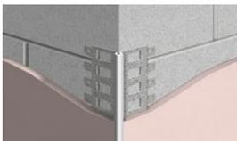
Das Kantenprofil besteht aus gelochtem und verzinktem Stahlblech mit weißem PVC-Überzug, der vor Abrieb und Korrosion schützt.
