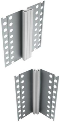
Das dreiteilige Profil aus verzinktem Stahlblech wird für alle gängigen Nassputzsysteme zum Herstellen von vertikalen Dehn- und Bewegungsfugen eingesetzt. Es ist für den Einsatz in ebenen Wandflächen und im Eckbereich bis 90° geeignet. Dehnfugenprofile überbrücken Fugen und nehmen Zug- oder Druckbewegungen auf wodurch Bewegungsrisse in der Putzfläche verhindert werden.
